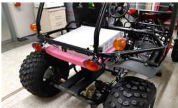
배터리팩 장착 및 라인구성
